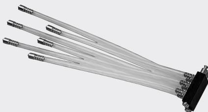
39100 VA **Spülverteiler**, für die maschinelle Aufbereitung, mit 2 Eingängen und 6 Ausgängen, zum Konnektieren von bis zu 6 Instrumenten mit LUER-Lock Anschluss, zur Direktkonnektierung im RDG, Außenmaße (L x B x H): 70 x 30 x 35 mm
